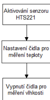
Obr. 16: Vývojový diagram pro aktivaci konkrétního čidla
