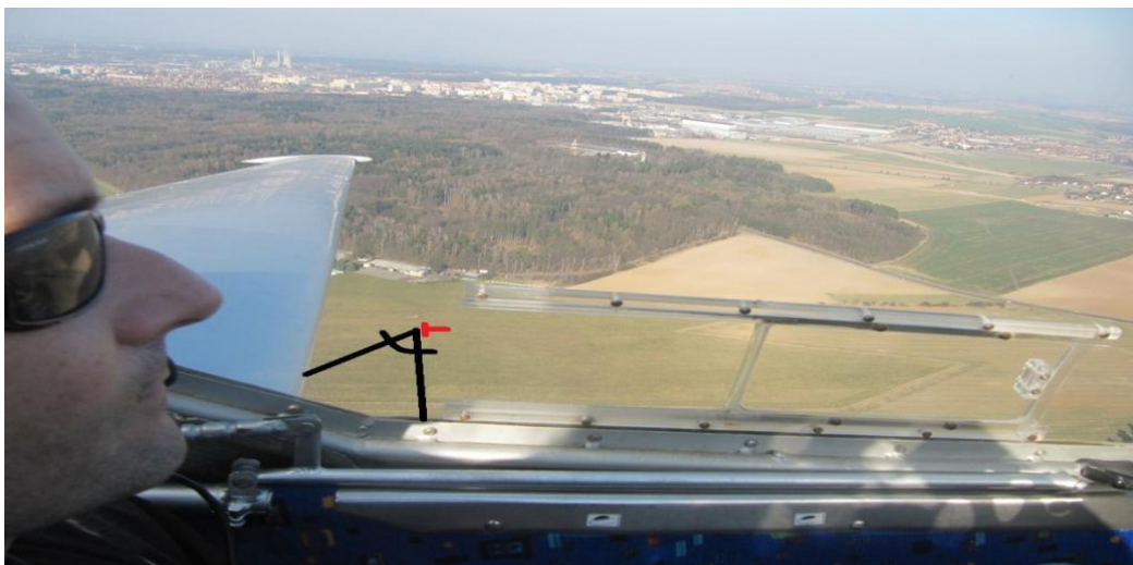
Obr. 4: Nedostatečný odstup od letiště
