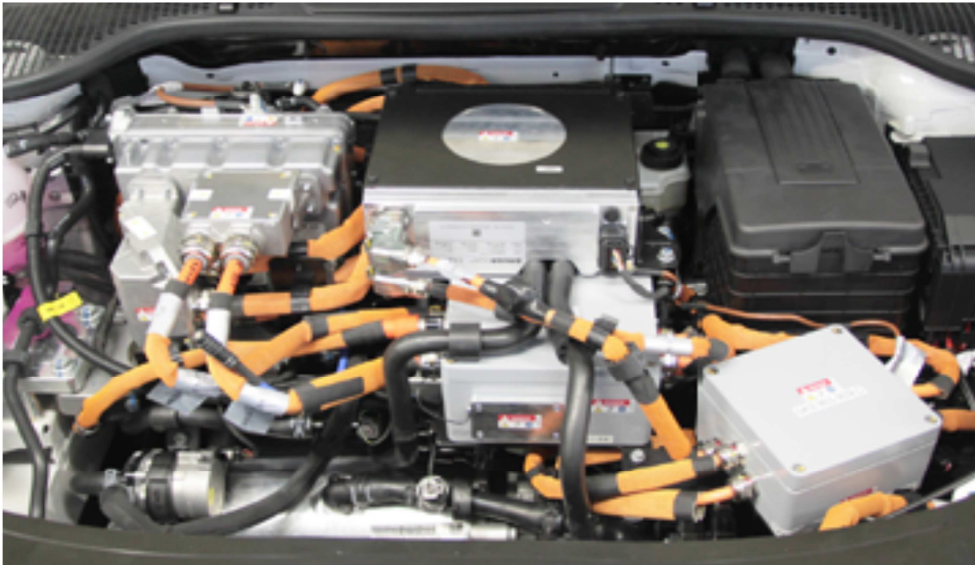
Vysokonapěťové rozvody ve vozidlech Škoda
