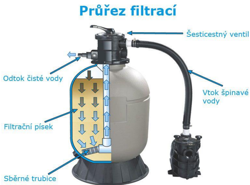
Obrázek 21 - Písková filtrace
