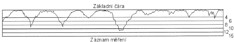
Obrázek 9: Viagram mechanického záznamu podélných nerovností
