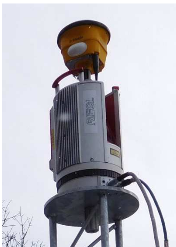
Obrázek 27: Laserový skener RIEGL VZ400 s GPS anténou TRIMBLE
