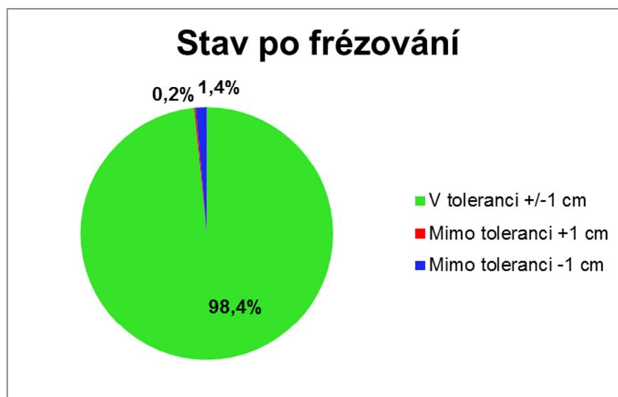
Graf 3: Vyjádření rovinnosti mezi 3D projektem a stavem po frézování vozovky
