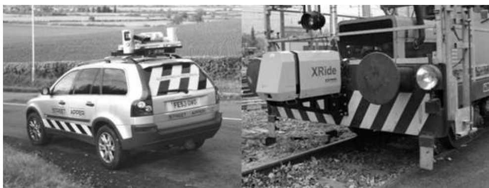
Obrázek 15: Lasery umístěné na automobilu a na drezině
