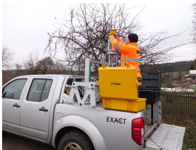
Obrázek 31: Instalace laserového skeneru na vozidlo
