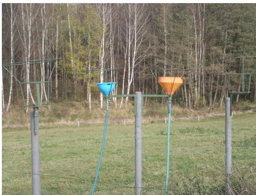
Obrázek 101 - sběr srážek v profilu CZ26 - Oldřichov v Hájích
