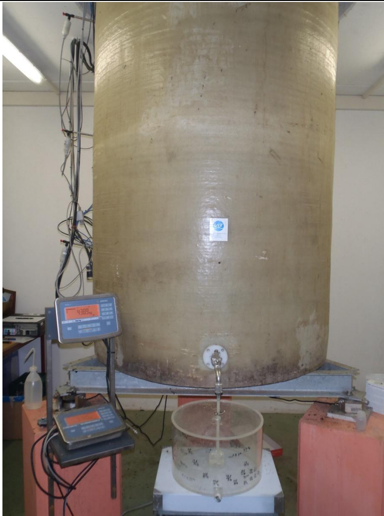
Obrázek 17 - podzemní část lyzimetru s měřicím zařízením
