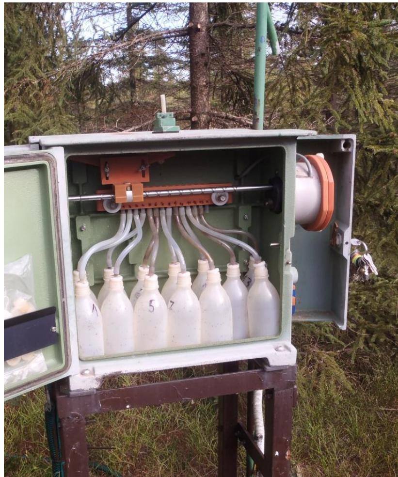
Obrázek 99 - automatický vzorkovač srážek v Uhlířské
