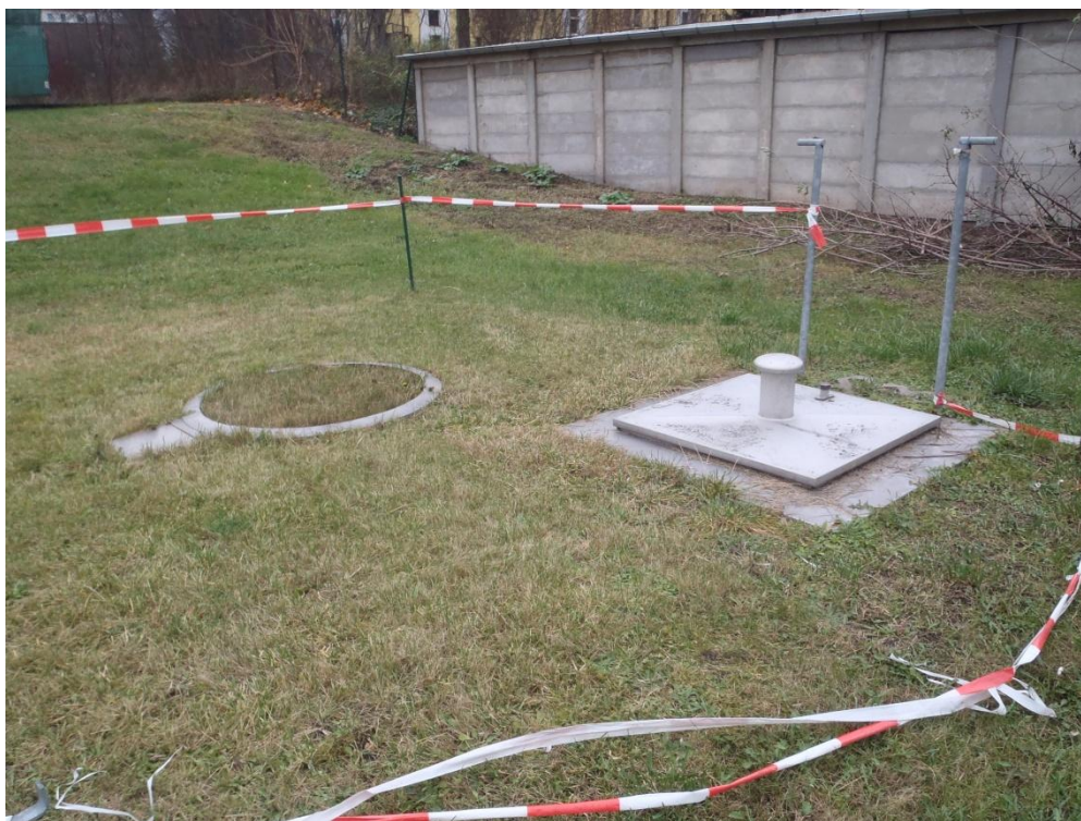
Obrázek 16 - půdorys lyzimetru (vlevo) a vstupní šachta k lyzimetru (vpravo) v Žitavské výzkumné ekologické stanici
