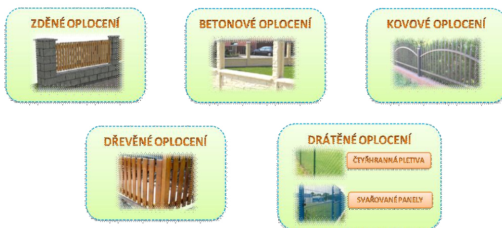
Obrázek 62: Základní výběr konstrukčně materiálové charakteristiky oplocení Zdroj: Vlastní zpracování, program Microsoft Excel
