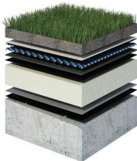
Obr. 11: Skladba zelené střešy [5]
