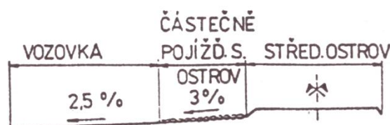
Obrázek 15: Příčný řez částečně pojižděného středního ostrůvku
