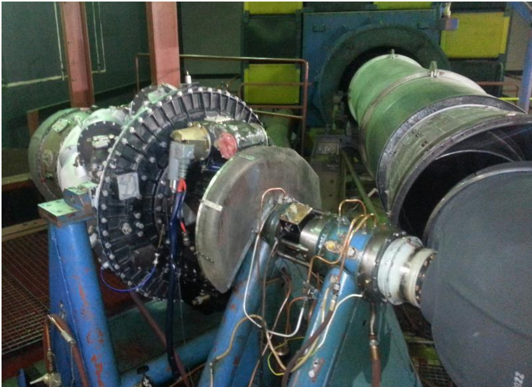
Obr. 30 Napojení motoru na vzduchovou brzdu M 701 s měřičem kroučícího momentu
