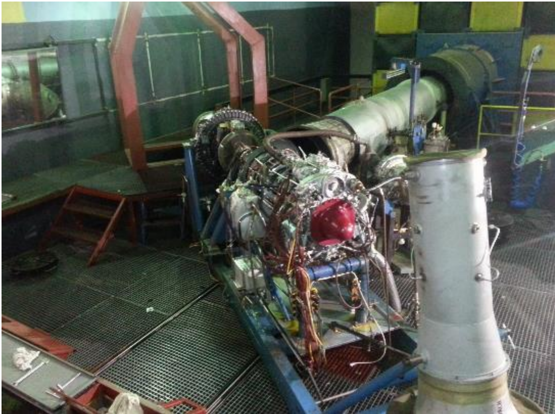
Obr. 31 Zkušební stojan č. 6 s ustaveným motorem a odpojeným vstupním ústrojím
