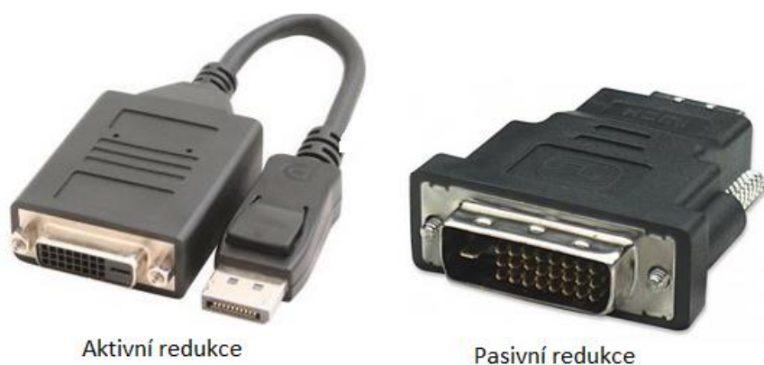
Obr. 43: Aktivní + pasivní redukce pro zapojení AMD Eyefinity [41, 42]
