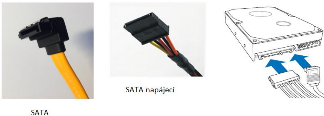
Obr. 35: Kabely SATA a SATA napájecí pro zapojení pevného disku [38]
