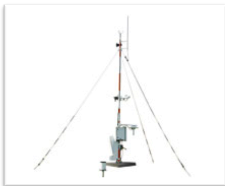
Obr. 12 Automatická meteorologická stanice AWS 520
