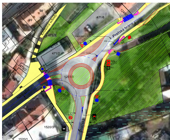
Obrázek 6.1: Schema navržené OK - křižovatka Na Podolci (mapový podklad: [6])
