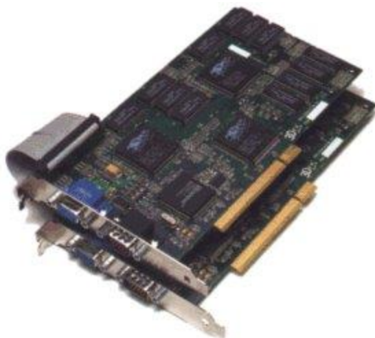
Obrázek 5 - Propojení dvou karet Voodoo 2 do režimu SLI
