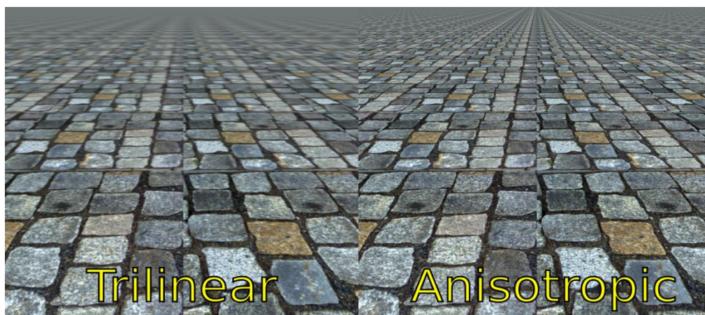
Obrázek 17 - Ukázka rozdílu mezi trilineárním a anizotropním filtrováním. V levé části je vidět rozmazání obrazu dané pevným poměrem stran textury.
