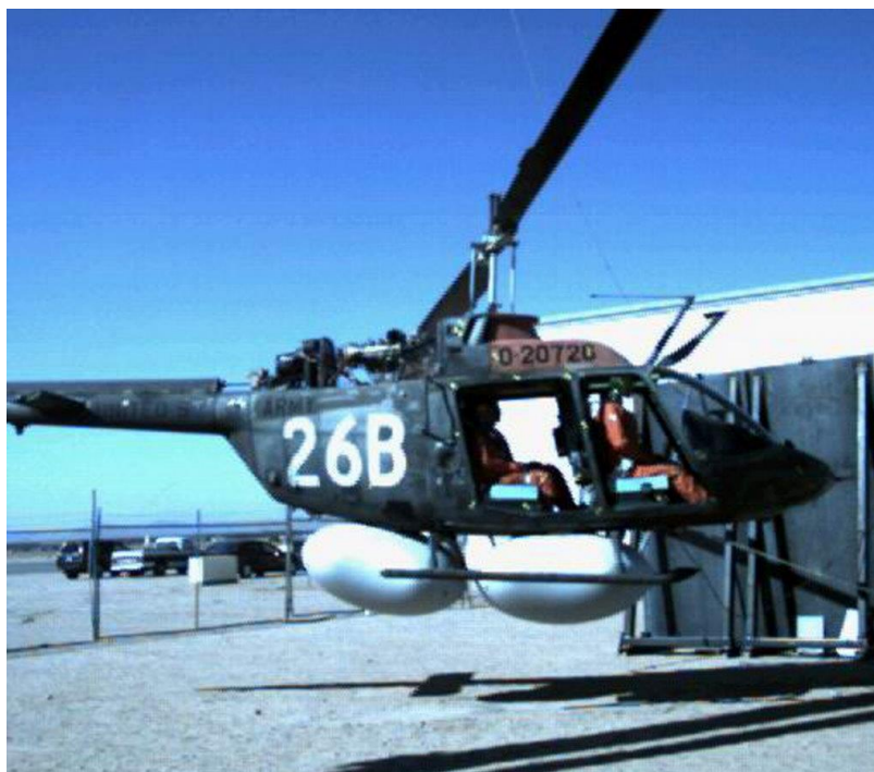
Obrázek 15. Test vnějších airbagů umístěných na vrtulníku Bell 206. [40]
