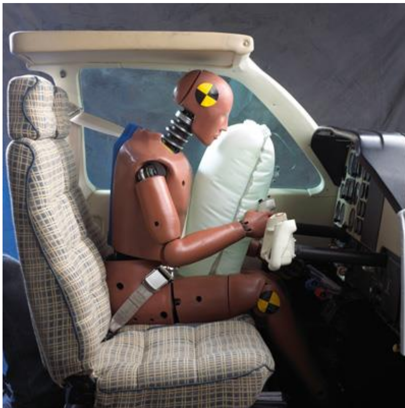
Obrázek 6. Aktivovaný airbag, během zkoušení za pomoci zkušebního vozíku. [5]
