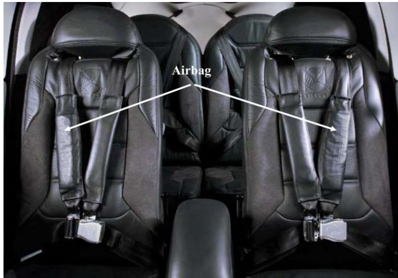
Obrázek 5. Příklad umístění airbagů uvnitř vnějších ramenních popruhů u letadla Cirrus. [5]
