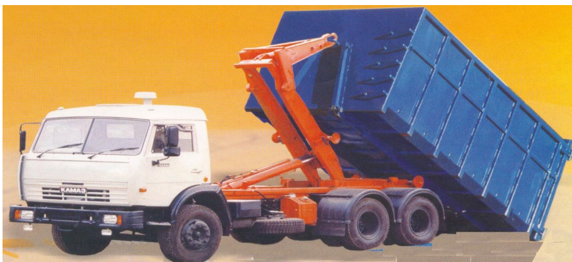
Obrázek 6.2 - Nákladní vozidlo KAMAZ-53205, vybaveno systémem „VIM-LIFT“
