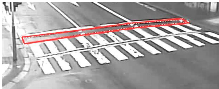
Obrázek 37: Oblast detekce při stop-čáře [39]. Upraveno.
