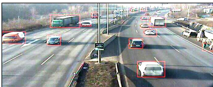
Obrázek 9: Výsledek označení objektů pomocí popsané metody [17].
