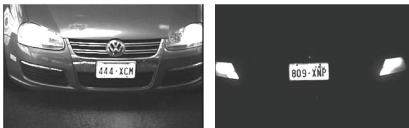
Obrázek 12: Snímek pořízení LPR kamerou ve dne (vlevo) a v noci (vpravo) [22].
