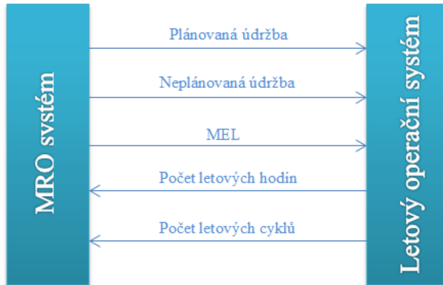
Obrázek 15: Propojení mezi MRO a letovým operačním systémem
