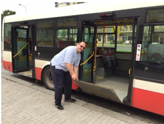
Obrázky 3-6 - Sklápění plošiny pro nástup vozíku u autobusu SOR (autor)
