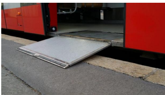
Obrázky 7-8 - Sklápění plošiny pro nástup vozíku tramvaje 15T (autor)
