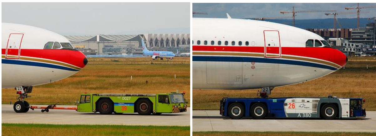
Obrázek 14 a 15 – Ojový a bezojový tahač. Zdroj: [97]
