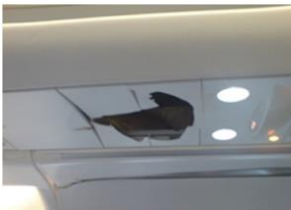
Obrázek 7: Proražený panel prostoru nad hlavou cestujících*
