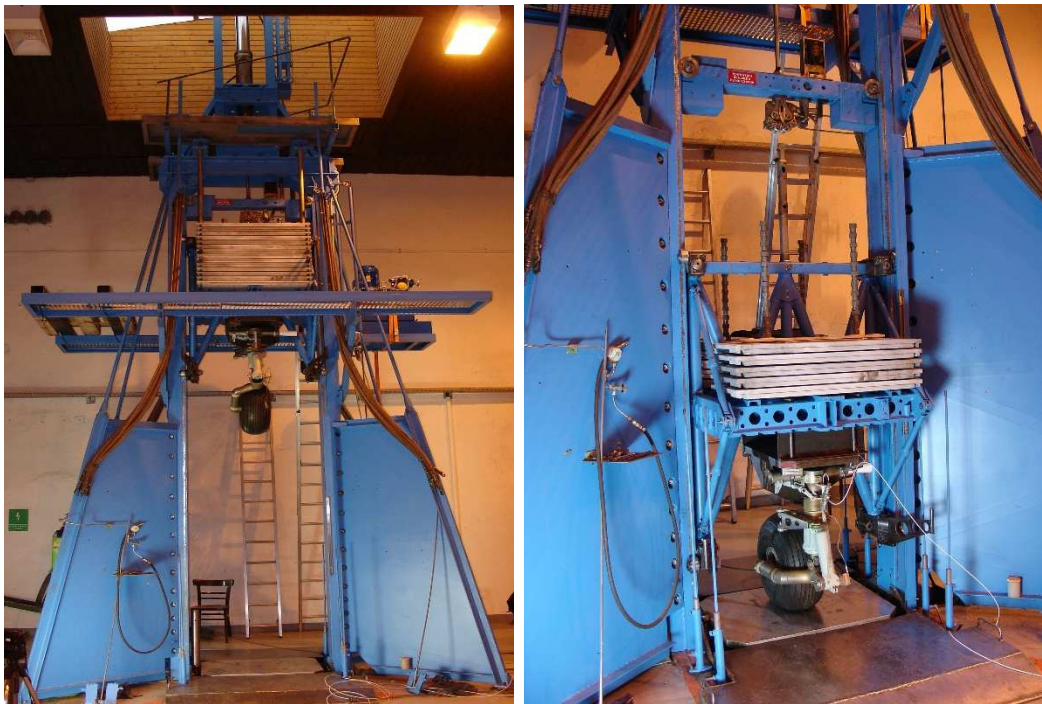
Obr. 25. Nebezpečí přimáčknutí nebo rozdrcení částí těla od zavěšených jednotlivých částí stroje určených k manipulaci.
