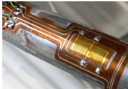
Obr. 25. Ukázka umístění (nalepení) odporového tenzometru na válcovém „trnu“.
