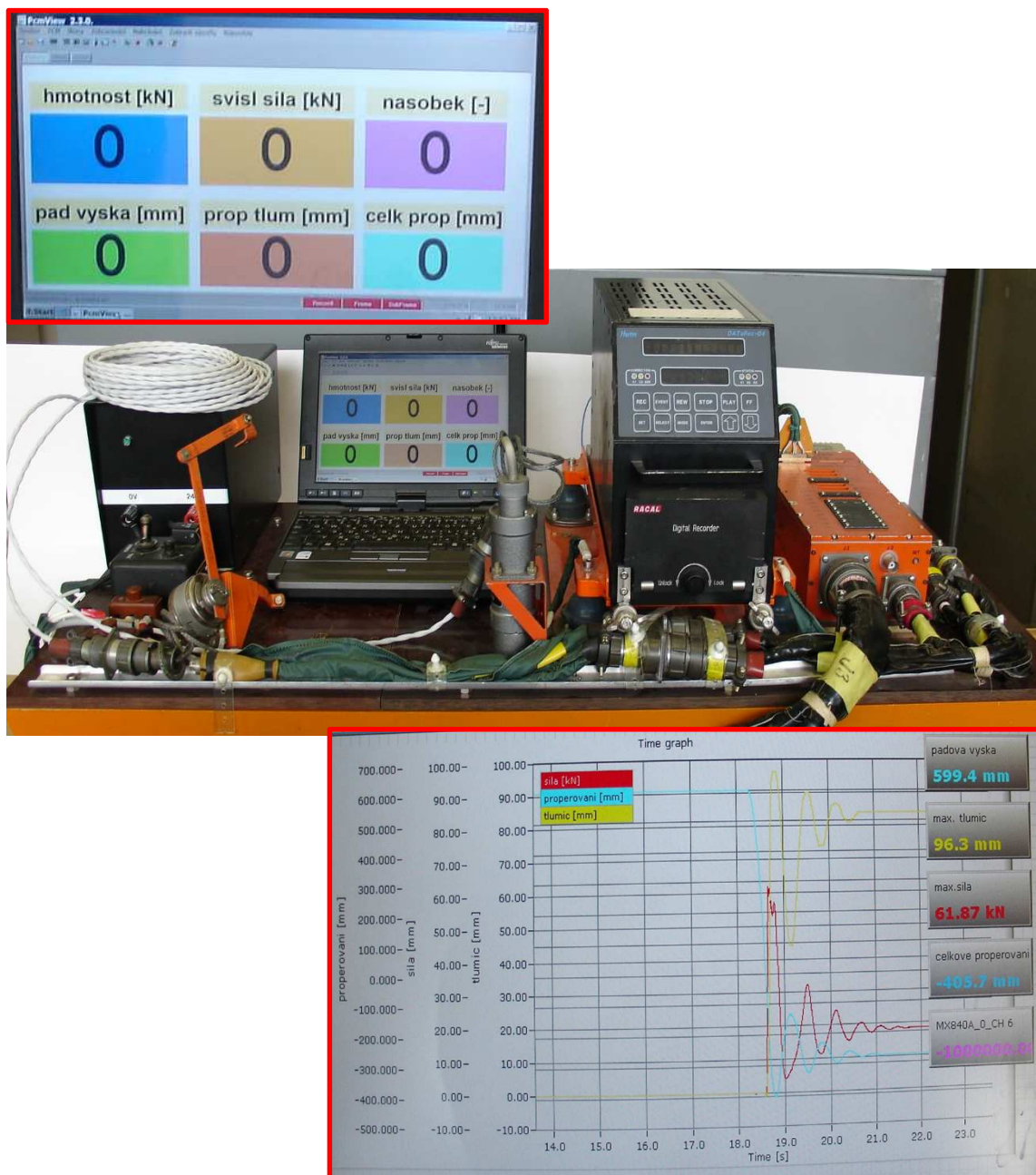
Obr. 51. Realizovaný nový měřicí řetězec určený pro dynamické zkoušky podvozků.
