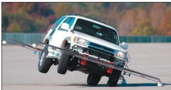
Obrázek 14 – Bezpečnostní opěry při reálném testu 15
