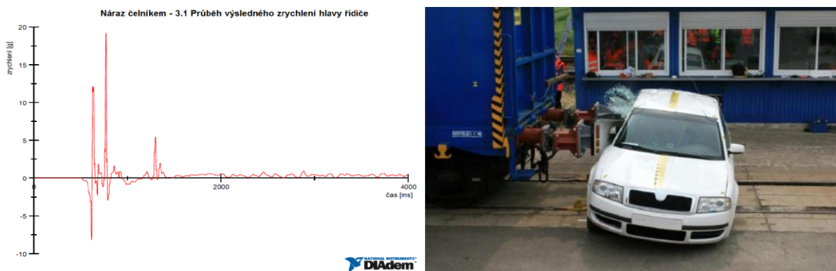
Obrázek 1: Průběh nárazové zkoušky kolize kolejového segmentu s osobním automobilem. [7]
