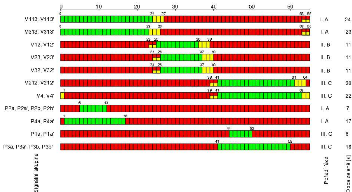
Obr. 25 Signální plán 65-ti sekundového reálného cyklu
