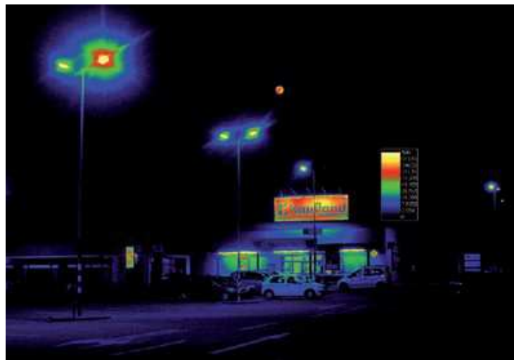
Obrázek 14 – Ukázka podílu světla vyzařovaného do horního poloprostoru [30]
