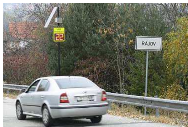
Obrázek 46 - Zvýraznění vjezdu do obce pomocí radaru zobrazujícího rychlost
