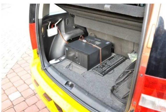
Obrázek 7 - HW modulu pro sběr dat – interní část
