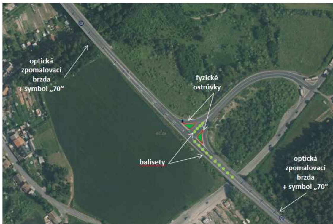
Obrázek 25 - Schéma řešení křižovatky I/7 x II/118
