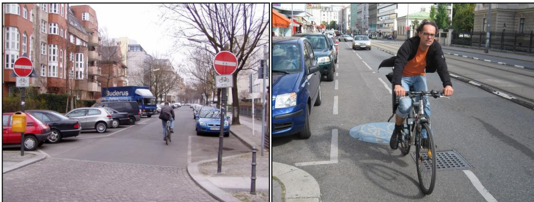
Obr. 7 a 8 – Vlevo: Jednoduché provedení „jednosměrky“ s obousměrným provozem cyklistů v Berlíně (zdroj: EDIP s.r.o.), vpravo: Značení vyhrazeného pruhu pro cyklisty v rámci HDP jako stezky pro cyklisty ve Vídni (zdroj: Pavel Skládaný)
