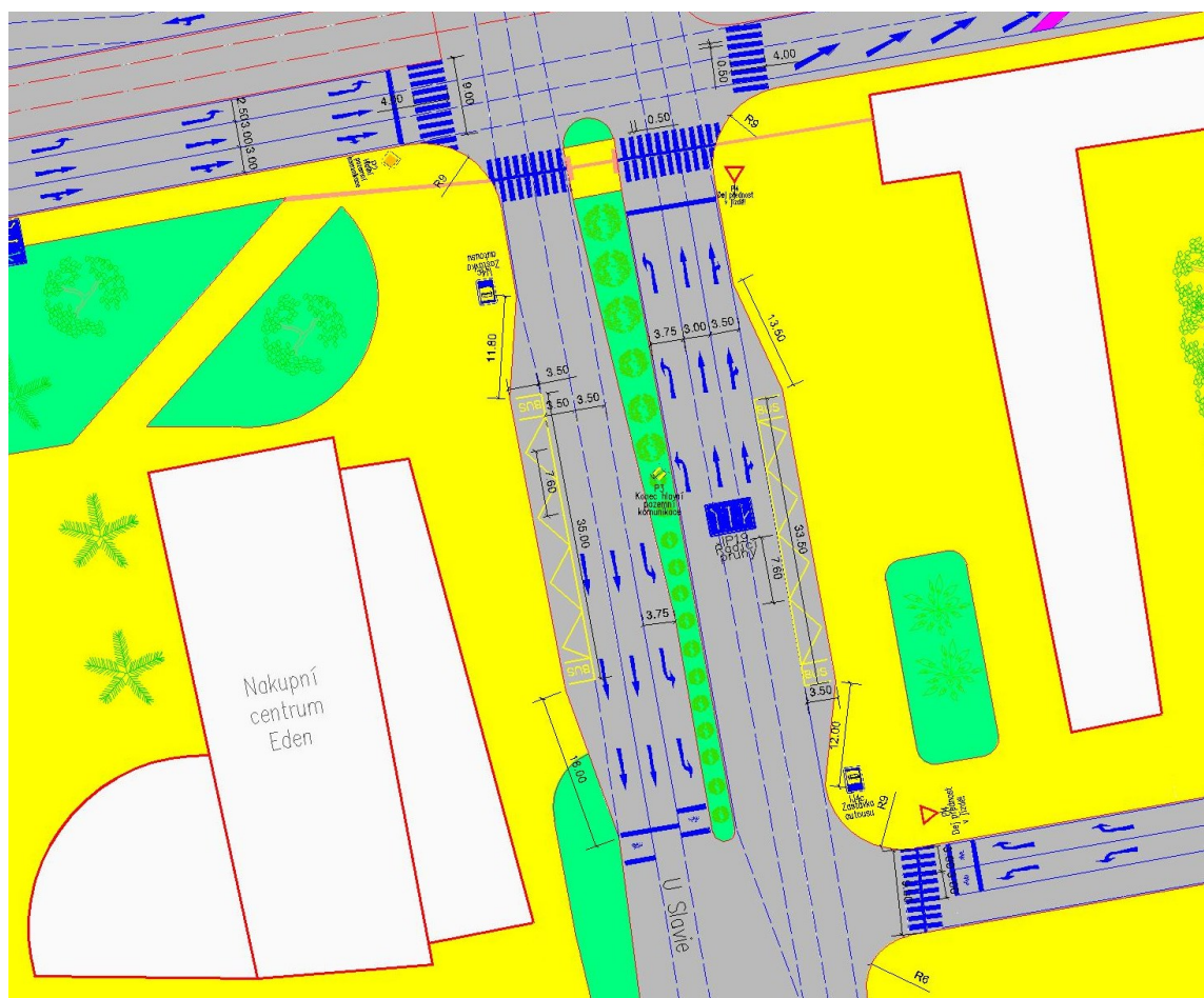
Obrázek. 28 Půdorys nově navržené autobusové zastávky v zálivu
