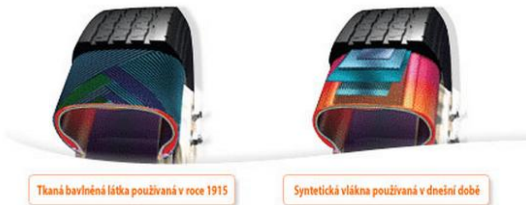
Obrázek 4.4 – Grafické znázornění diagonální (vlevo) a radiální (vpravo) pneumatiky. [23]
