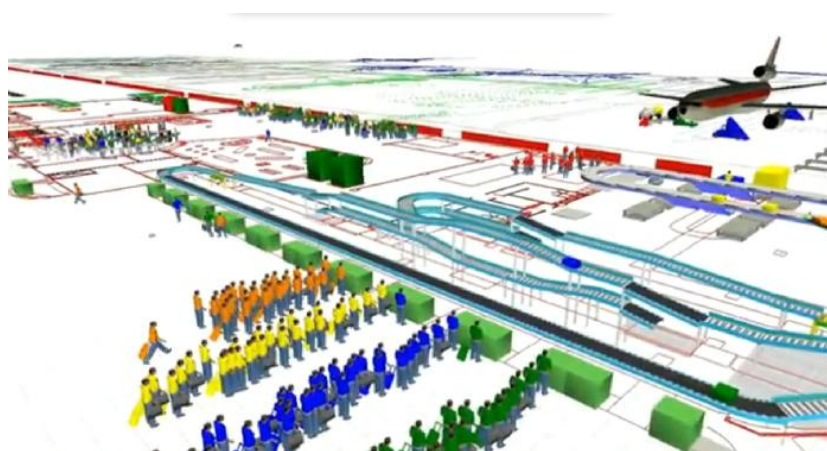
Obr.: 58 Výsledný model procesu odbavení cestujících vytvořený pomocí programu FlexSim (Zdroj: [45])
