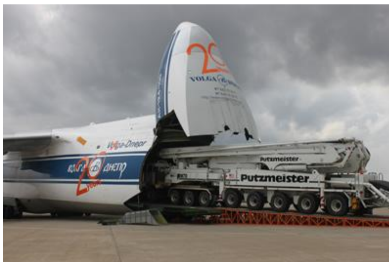
Obrázek 9 - Nakládání An 124 pomocí speciálně vytvořené rampy
