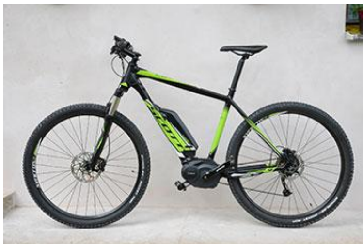
Obrázek 6: Motor uložen ve středu kola od firmy BOSCH (APACHE Hawk Bosch Active 400Wh 2015, 2015)
