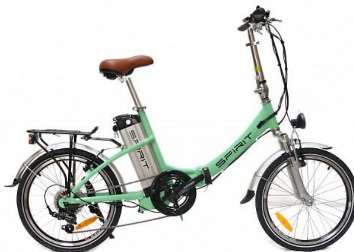
Obrázek 7: Od skládaček po velká horská kola. Všechna využívají napětí 36 V (Elektrokolo Spirit JOY2 "skládačka", 2014).
