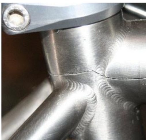
Obrázek 13: Prasklý hliníkový rám není neobvyklý (Aluminium Bike Frame Repair, 2014)
