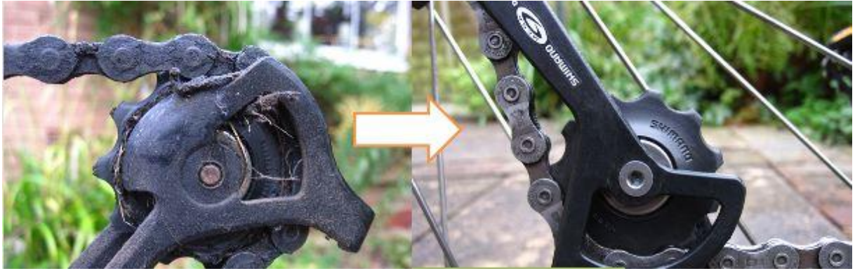
Obrázek 15: Rozdíl ve tření není zanedbatelný (cleanbikevsdirtybike.png, 2010)
