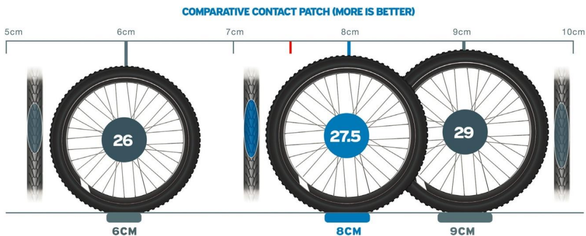
Obrázek 18: Porovnání trakce ráfků (POROVNÁNÍ VELIKOSTI RÁFKŮ, 2014)
