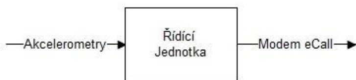
Obrázek 4.3: Schéma vstupů a výstupů řídicí jednotky pro rozeznání typu nehody systémem eCall
