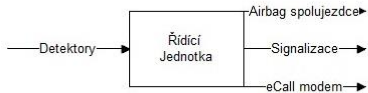
Obrázek 4.1: Vstupy a výstupy řídicí jednotky pro detekci dítěte pro systém eCall
