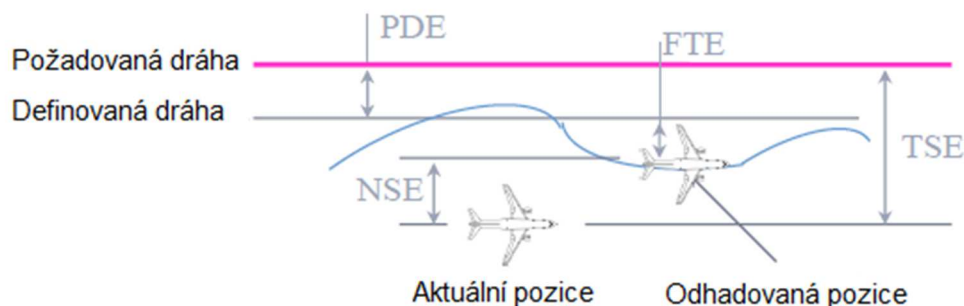
Obrázek 19 - Znázornění celkové chyby systému TSE zahrnující NSE (Navigation system error, Navigační chyba systému), PDE (Path definition error, Chyba definice dráhy) a FTE Flight technical error (Letově-technická chyba) [13], (upraveno autorem)
