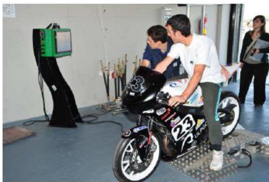
Obrázek 15: Zkušební stav, na kterém bude v rámci soutěže provedena zkouška brzd [1]
