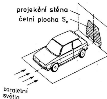
Obrázek 11: Určení čelní plochy vozidla, která je vstupem do výpočtu vzdušného odporu [13]
