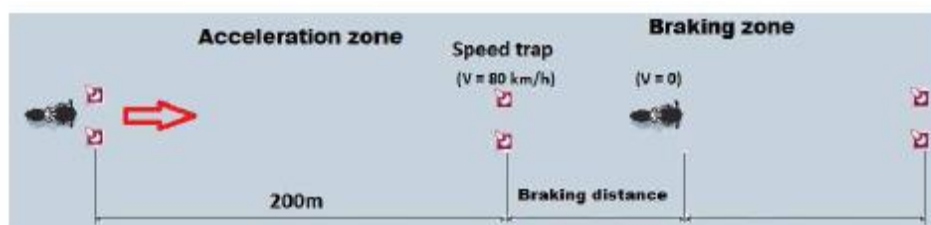
Obrázek 16: Schématické znázornění průběhu zkoušky brzdné dráhy [1]
