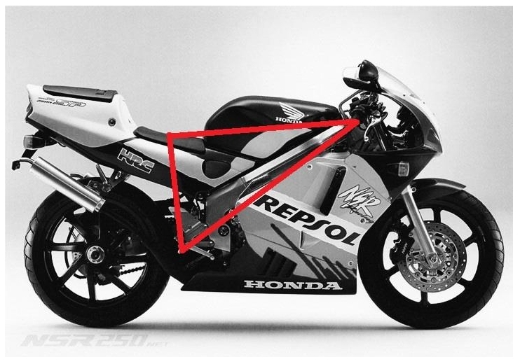
Obrázek 6: Trojúhelník posedu pro supersportovní motocykl Honda NSR250 má téměř vodorovnou horní stranu
