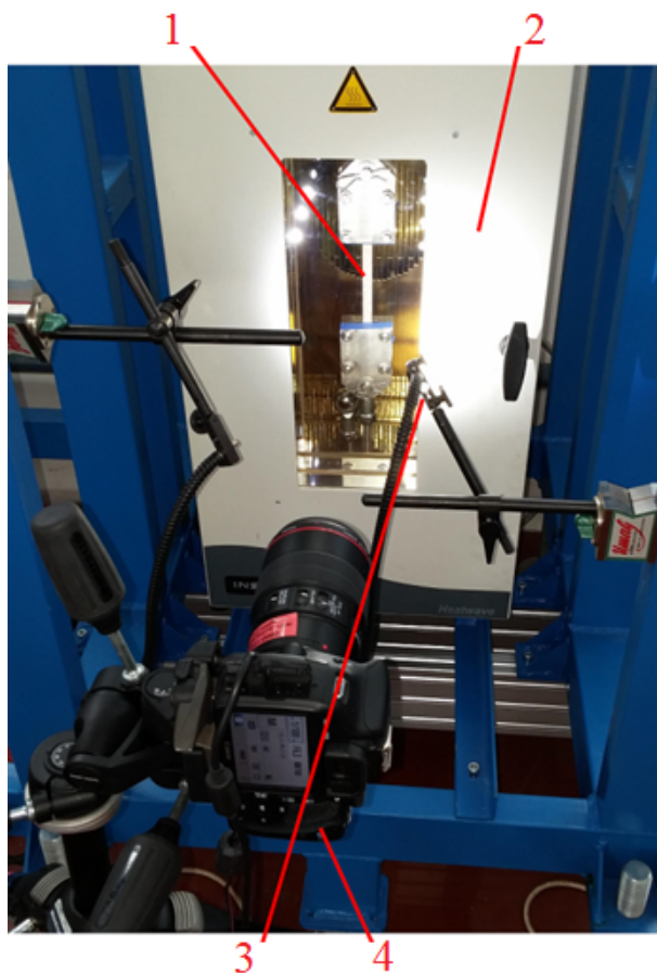
Obrázek 3.5: Uspořádání experimentální sestavy pro zkoušku tečení 1-vzorek, 2-topná komora, 3-LED osvětlení, 4-digitální fotoaparát [4]
