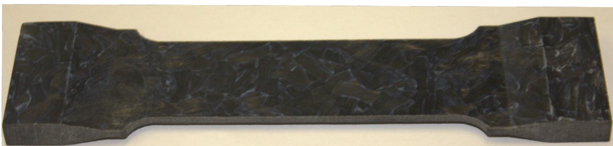
Obrázek 3.2: Povrch vzorku z peletek typu Carbon AS4/PPS se zesílenými konci
