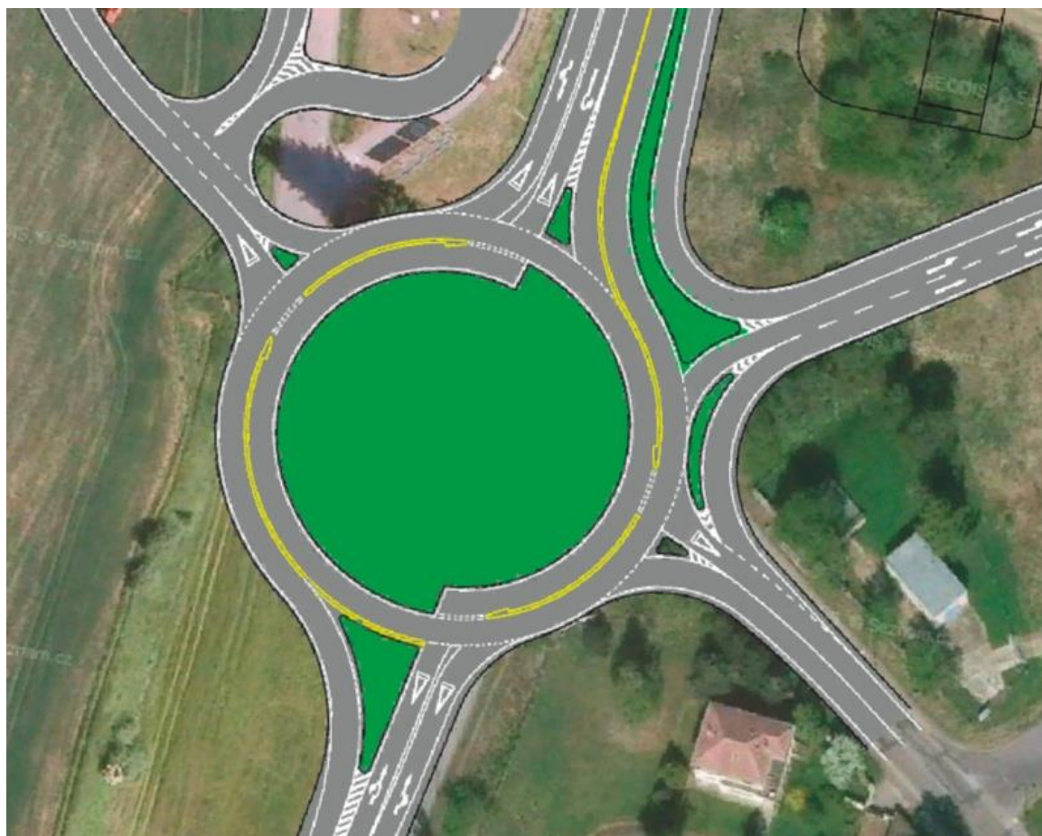
Obr. 14 Turbookružní křižovatka (Zdroj. http://silnice-zeleznice.cz )
