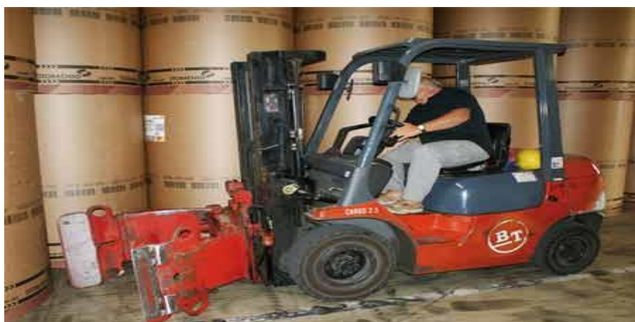
Obrázek 4. Manipulace a skladování rolí s klešťovým vozíkem. (Zdroj: [19])
