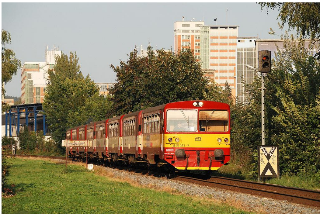
Obr. 5: dnes již spíše vzácností jsou na trati 331 soupravy motorových vozů 810 a přívěsných 010. Efektivitu provozu snižovala zejména nutná přítomnost strojvedoucího v každém z motorových vozů. Mezi fanoušky železnice si souprava vysloužila přezdívku ropovod (foto: Tomáš Kudláček, zelpage.cz)
