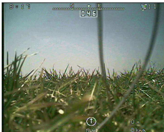
Obr. 39 – Video obraz přenášený z vrtulníku s letovými údaji přidávanými TeleFlyOSD. Zleva v horní části obrazovky je letový čas, kurz a počet viditelných GPS satelitů. Ve spodní části je zleva zobrazen šipkou směr k Home (pozemní stanici) a vzdálenost v metrech (NA je zobrazeno z důvodu, že nebyl nastaven Home), výška v metrech a rychlost letu v km/h.
