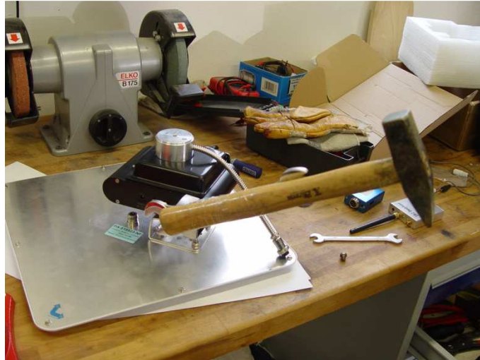
Obr. 37 – Provizorní protizávaží směrové antény skládající se z kladiva a klíčů na utahování matic.
