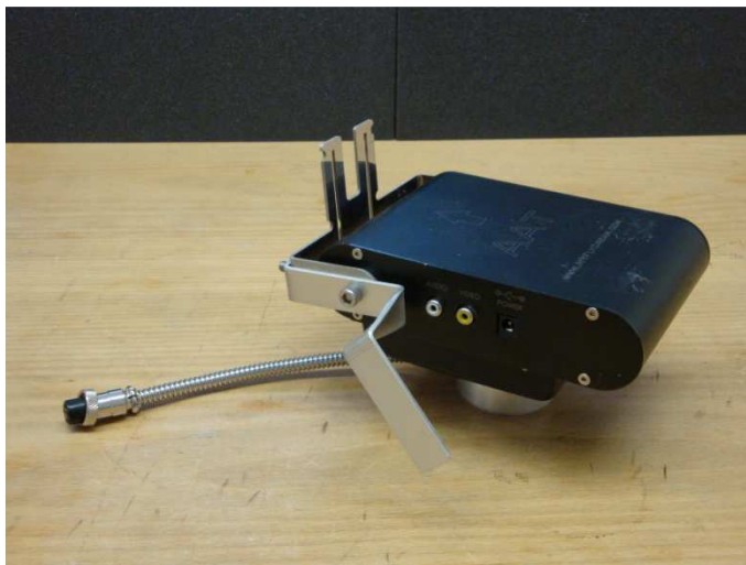
Obr. 15 – AAT Tracker s ramenem pro připevnění vyvažovacího závaží.
