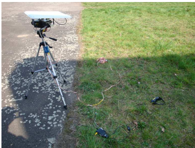
Obr. 31 – Pozemní stanice v uspořádání bez video rozdělovače a grabberu.
