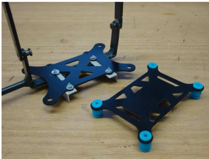
Obr. 36 – Rozložená antivibrační deska připevněná pomocí dvou nosníků profilu L a šroubových spojů k otočnému držáku hlavní kamery.
