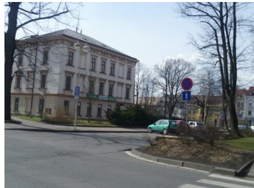
Obrázek 28 - Chybné společné umístění SDZ
