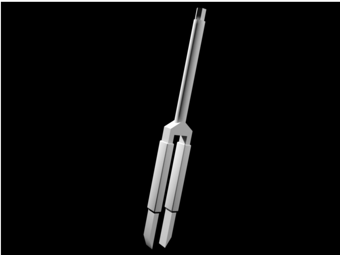
Obrázek 79 Model oboustranné osy - boční pohled
