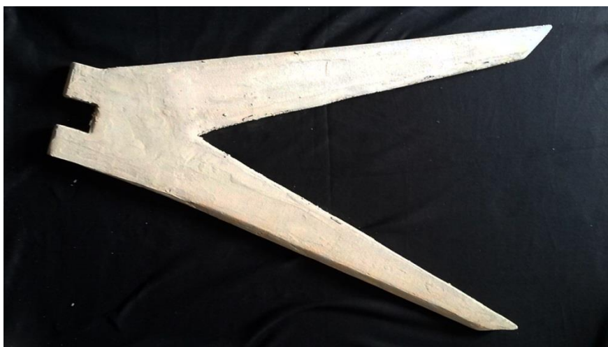
Obrázek 61 Model rámu cyklistického kola z extrudovaného polystyrénu
