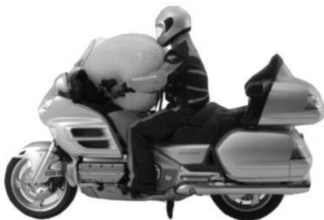
Obrázek 99 Realizovaný airbag na motocyklu
