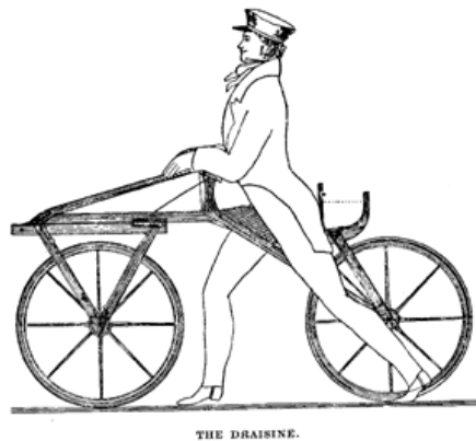
Obrázek 1 Odstrkovadlo vynalezené německým konstruktérem Karlem Draisem
