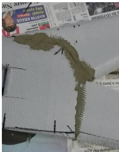
Obrázek 60 Lepení částí pomocí lepící stěrky
