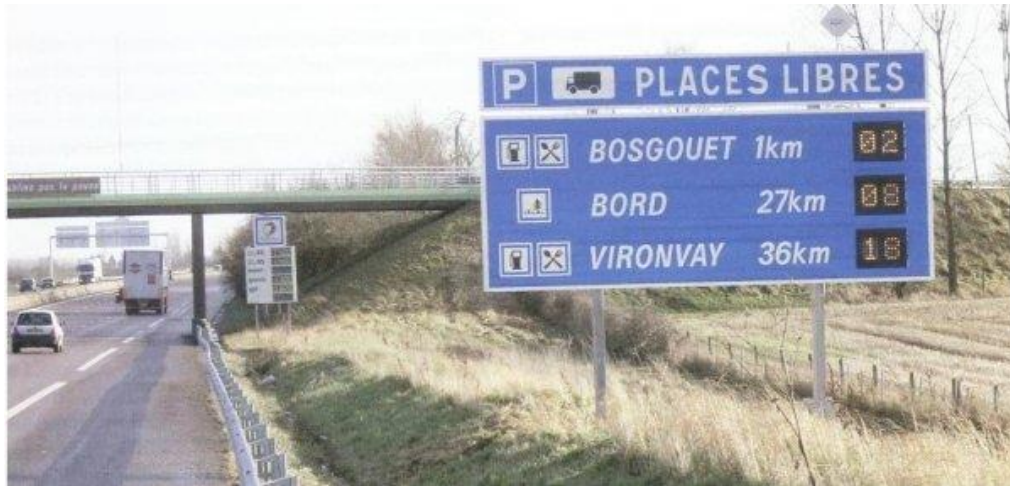
Obrázek 9: Proměnná dopravní značka společnosti SAPN zobrazující počet volných míst na parkovištích. Zdroj: [27]
