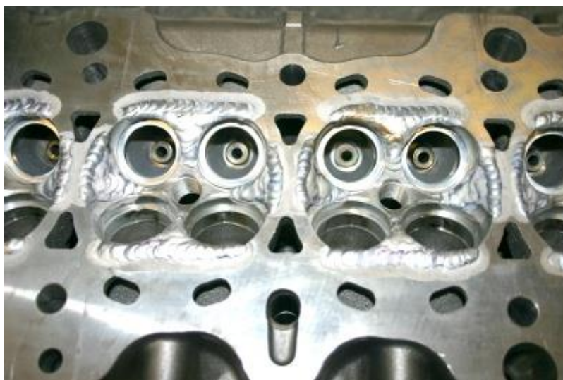
Obr. 20 Vyvařené spalovací komory před obráběním na CNC stroji [29]
