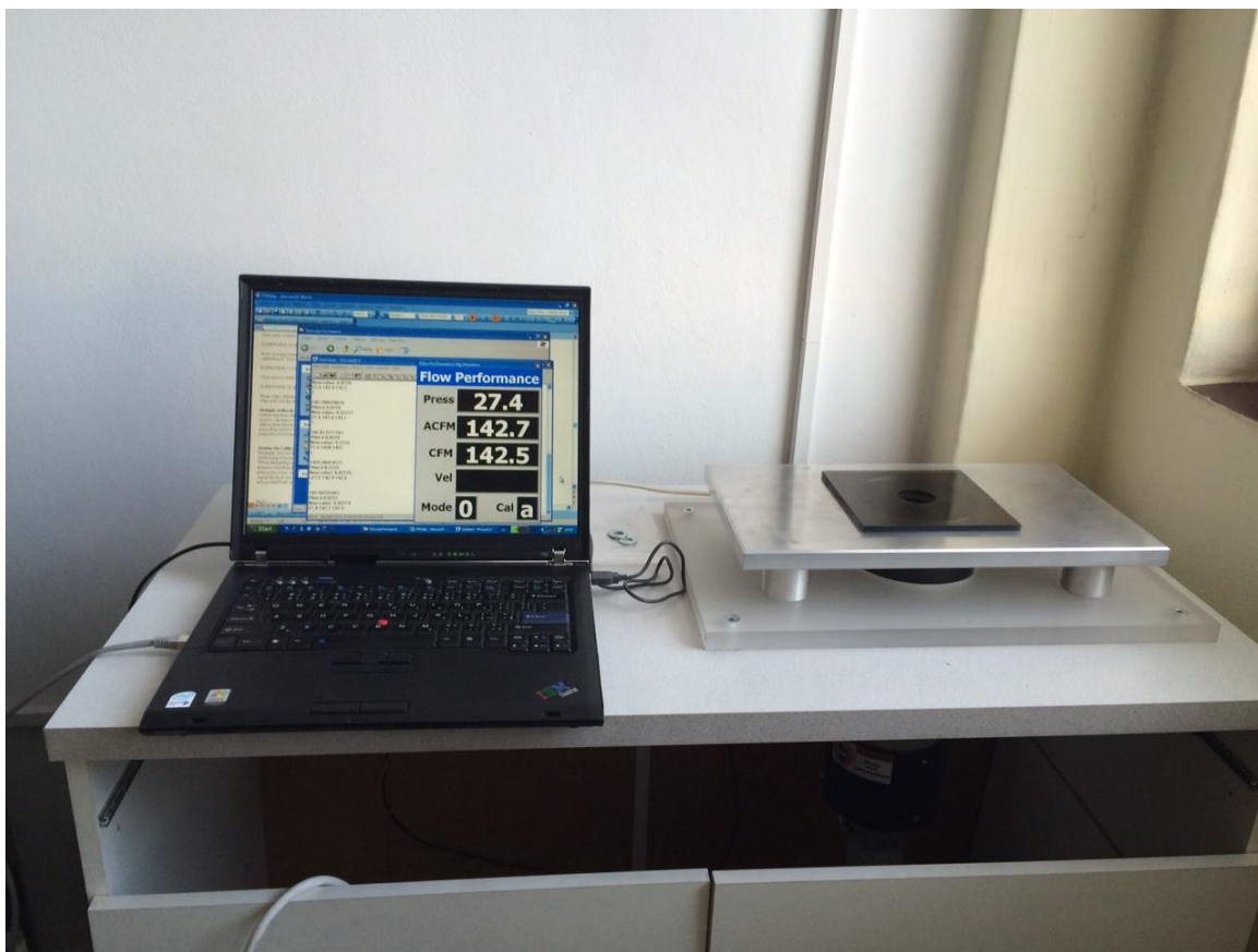
Obr. 16 Kalibrace měřicího přístroje Flow Bench pomocí certifikovaného kalibračního otvoru.
