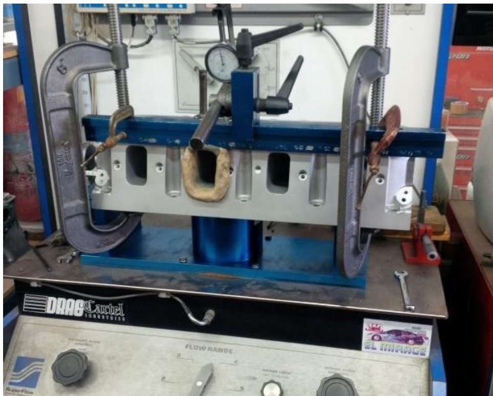
Obr. 13 Hlava válců připevněná na simulátor válce a zaoblené vodítka na testovaném sacím kanálu [21]
