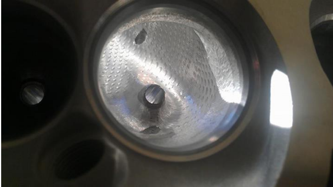
Obr. 17 Hlava válců LT1, Chevrolet 2014 – upravený sací kanál [26]
