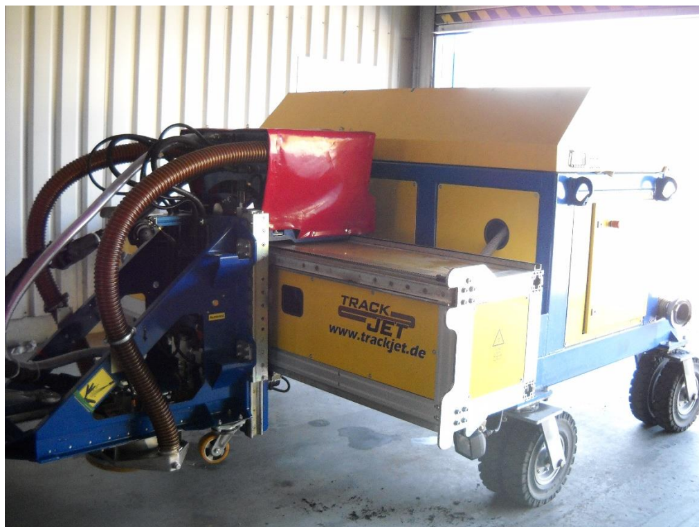
Obrázek 2.1. – Zařízení pro odstraňování gumy z povrchu vozovky
