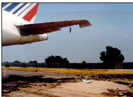
Obrázek 16: A- Pojízděcí dráha je poškozena výstupními proudy z motoru při zkoušce motoru. Výškovka letadla je zničena kusy asfaltu utrženého z komunikace.
