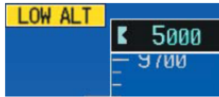
Obrázek 6.10 G1000 – Varování LOW ALT
