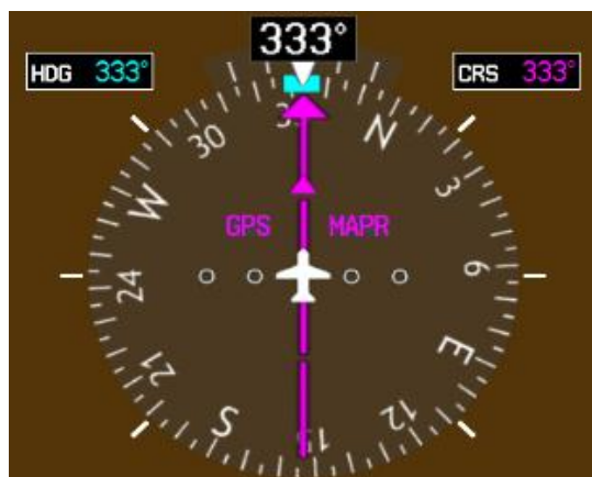
Obrázek 6.14 G1000 – indikace módu nezdařeného přiblížení
