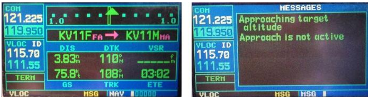
Obrázek 6.8 G430 – Chyba v aktivaci módu konečného přiblížení
