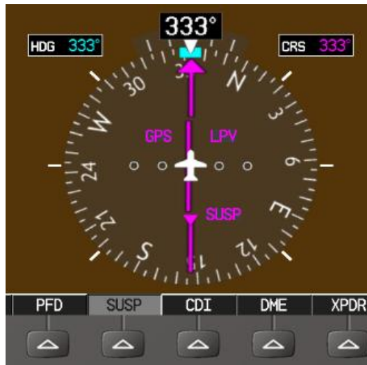
Obrázek 6.16 G1000 – systém připraven na aktivaci módu nezdařeného přiblížení
