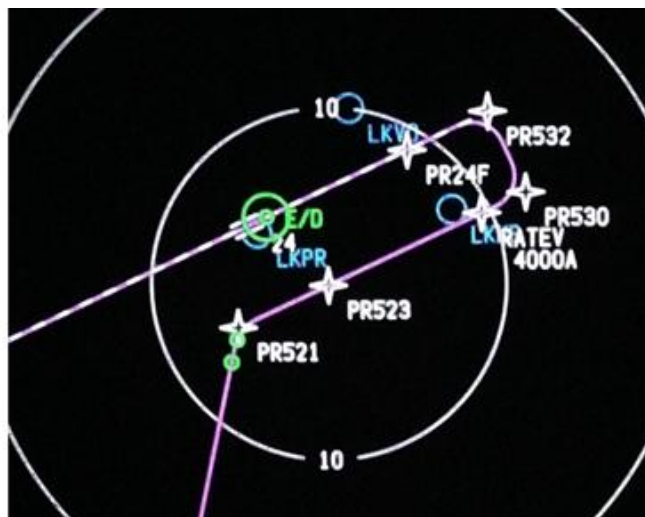
Obrázek 5.21 B737NG – CDU LEGS Page a ND v Plan Mode – kontrola nahrané procedury
