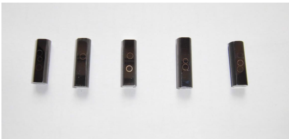
Obr. 16 - Vzorky z materiálu Vanadis 30 po zkoušce tříbodovým ohybem a měření odolnosti proti opotřebení. Řazeno z leva: 5K, 15K, 30K, 5Z, 5V
