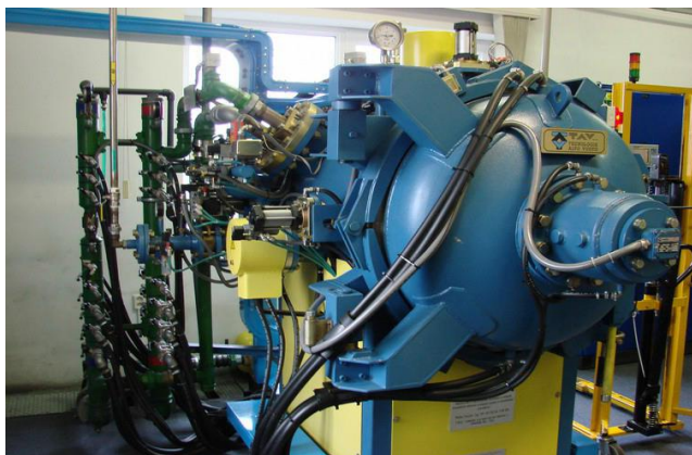
Obr. 12 - vakuová pec pro zpracování vzorků [11]
