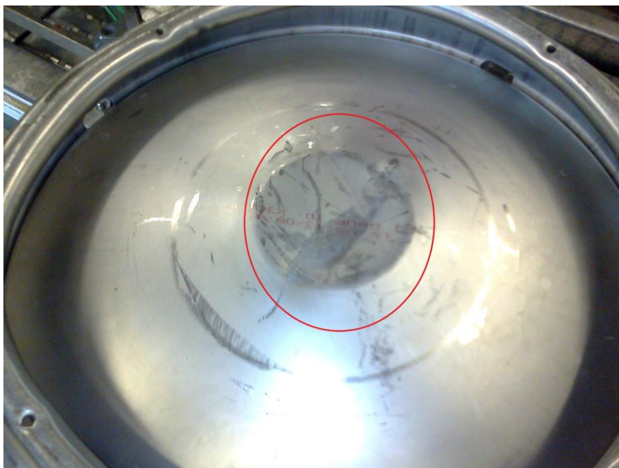
Obr.25 Porucha vyřazeného sudu kvůli deformaci
